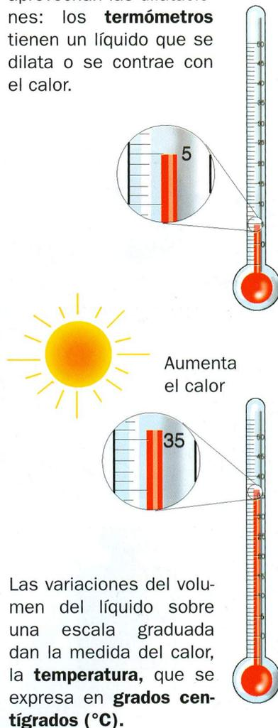
Las variaciones del volumen del líquido sobre una escala graduada dan la medida del calor, la **temperatura**, que se expresa en **grados centígrados (°C)**.
